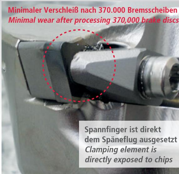
Spannfinger ist direkt dem Späneflug ausgesetzt
