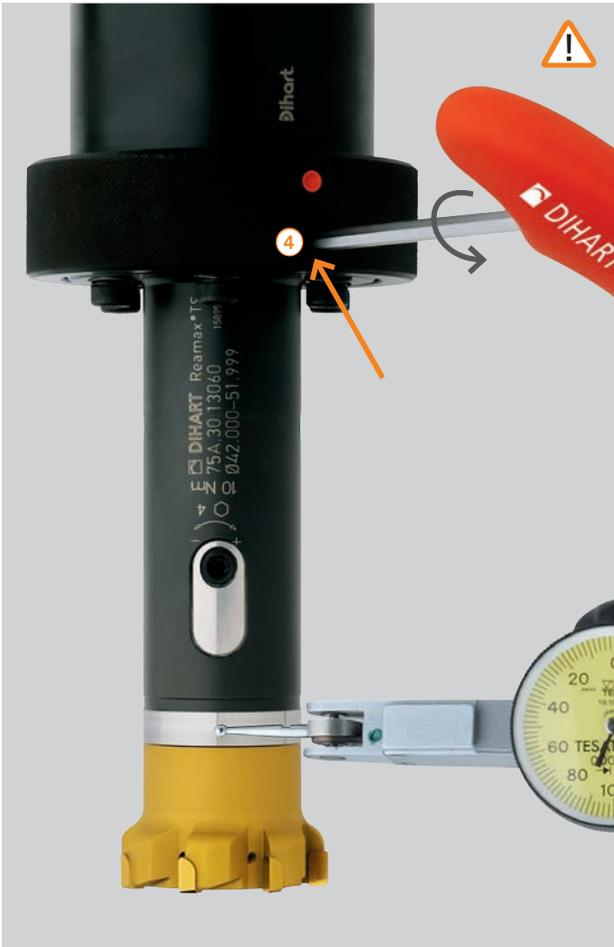
Регулировку оснастки DAH® выполнять на станке,
