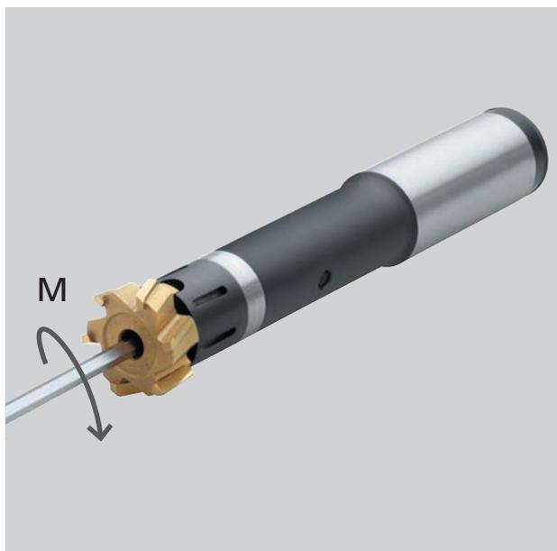
Быстросменные головки диаметром до 12,59 мм крепятся в державке сзади при помощи одного винта. Винт имеет левую резьбу.
