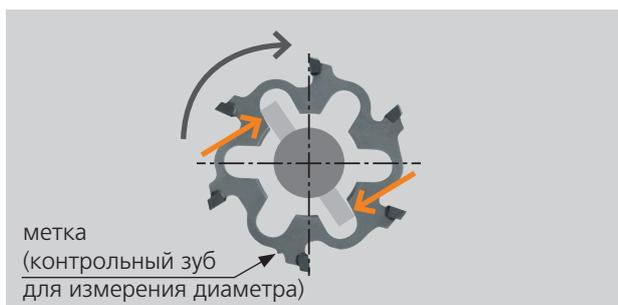
Правильное положение приводных штифтов определяется по выступу или красной метке. До окончательного затягивания и регулировки, повернуть режущее кольцо против направления вращения при обработке, до соприкосновения с приводными штифтами.
