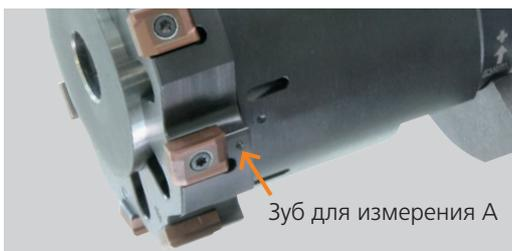
Измерение диаметра производить только по зубьям с метками (зуб для измерения А), из-за неравномерного углового расположения зубьев!
