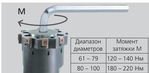
Навинтить гайку на державку гладкой поверхностью к втулке. Установить кольцо Duomax с помощью конического винта. После затягивания конического винта проверить наличие зазора между втулкой и кольцом Duomax. Затянуть конический винт в соответствии со значениями таблицы.
