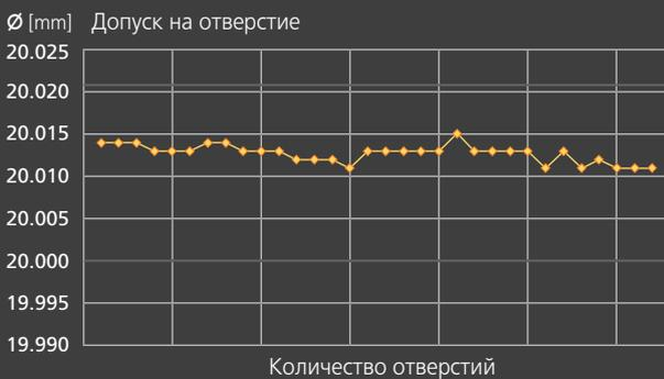
Точность замены головки KOMET DINHART REAMAX®
