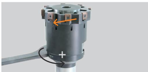
Совместить позиционные риски на державке и кольце Duomax, проверить правильность совмещения отверстий для подачи СОЖ. Настроить диаметр на середину поля допуска отверстия.
