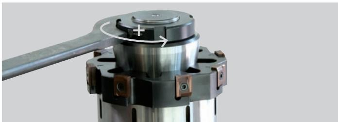
Настроить диаметр на середину поля допуска отверстия (левая резьба на гайке, затягивать против часовой стрелки).
